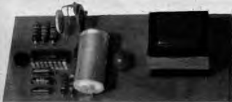
Fertig geschaltetes Netzgerät
